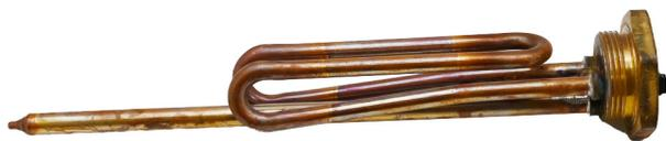
Per modelli 15 lt sopraavello 2 e 5 anni. 1500 W/230 V. Con sede anodo femmina D. 4 mm. Resistenza a vite. Lunghezza asta 26,5cm, curva 16 cm.
